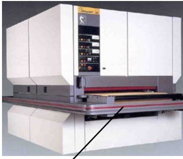
Not-Aus an Bandschleifmaschinen
