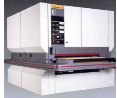
Not-Aus an Bandschleifmaschinen
