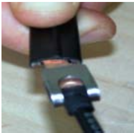
Bild 2 und 3: Kupferzunge zwischen die Kupferlagen des Bandschalters schieben. Die Metallklammer über den Bandschalter bis zum Anschlag schieben.
