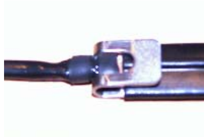
Bild 2 und 3: Kupferzunge zwischen die Kupferlagen des Bandschalters schieben. Die Metallklammer über den Bandschalter bis zum Anschlag schieben.
