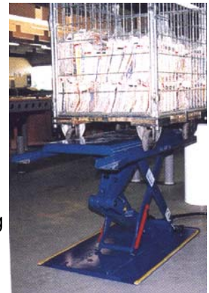
Quetschkantenabsicherung an Scherenhubtischen
